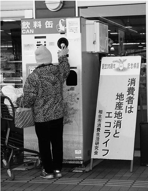
デポジット方式による缶回収機
