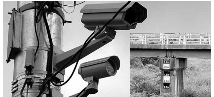
河川監視カメラ・水位計
