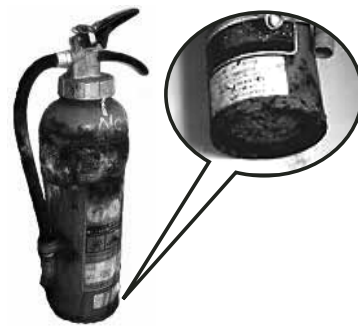
① 腐食した消火器
